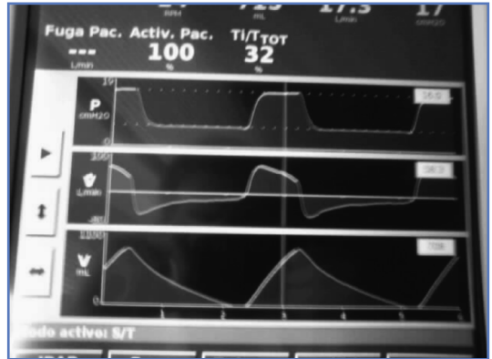
Figura 15.1. Curvas, de arriba abajo, de presión, flujo y volumen. La curva de flujo muestra un ascenso rápido inicial hasta alcanzar un valor máximo que determina el nivel de presión programado. Posteriormente se produce una caída de flujo que mantiene constante la presión y un descenso (final de la línea de color verde) que coincide con un 25% del valor máximo alcanzado, produciéndose el ciclado a espiración.
